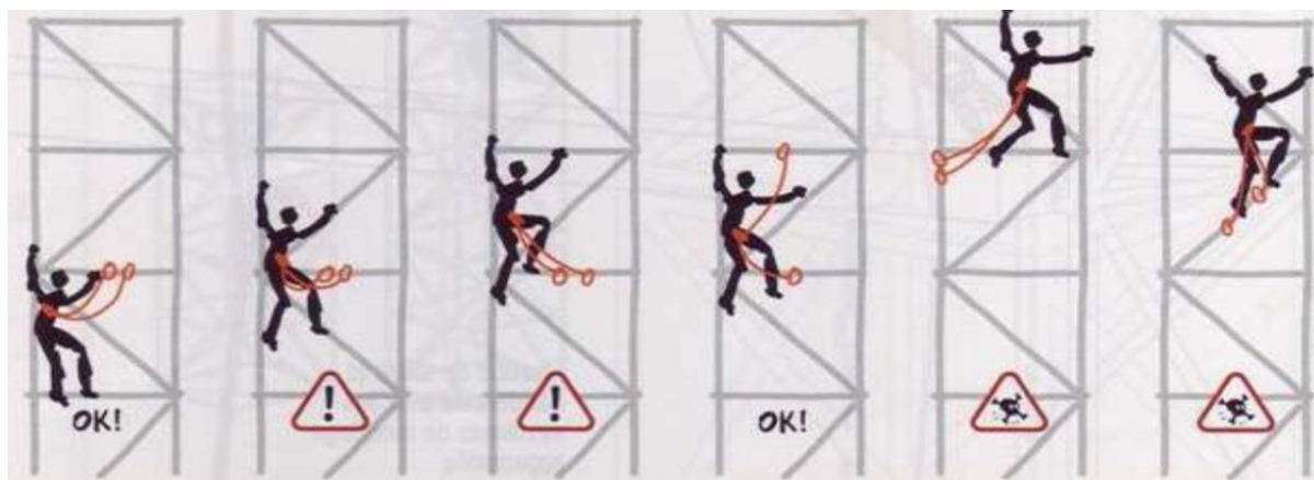
Obrázek 7 – Povolené a zakázané postupy při výstupu na příhradový stožár.
