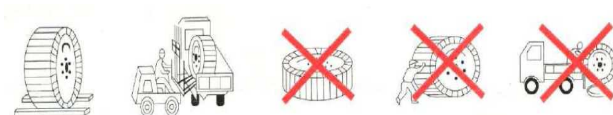
Schéma manipulace s OPGW (Obrázek 1)
