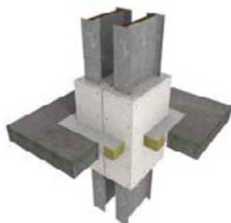
Detail A1 - prostup s obkladem z desek PROMATECT®-H pro přípojniový systém s nulovou vzdáleností
