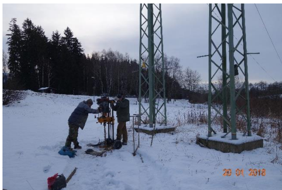
rohový Pb60 – hĺbenie sondy súpravou Minuteman mobile drill
