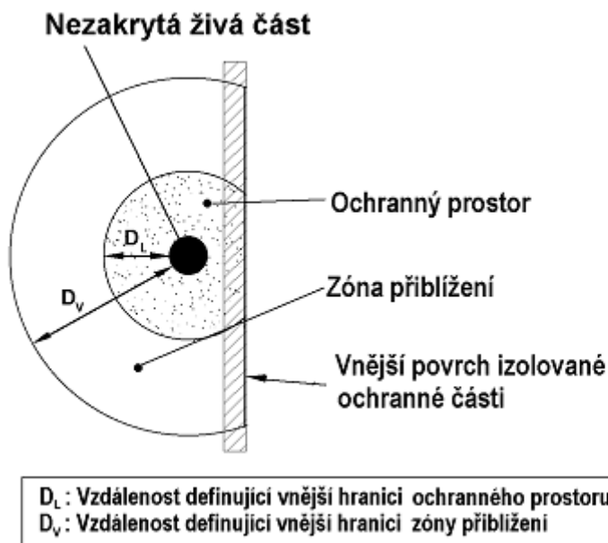
Obrázek 1 - Vzdušné vzdálenosti a zóny pro pracovní postupy
