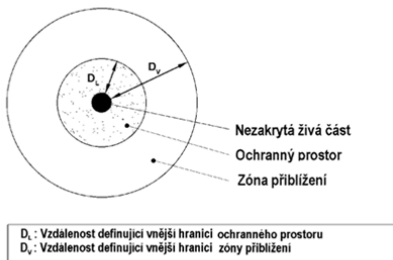
Obrázek 1 - Vzdušné vzdálenosti a zóny pro pracovní postupy
